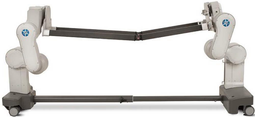
Abbildung 44: Für das Abnehmen der Holme konfigurierter ProAxis®
