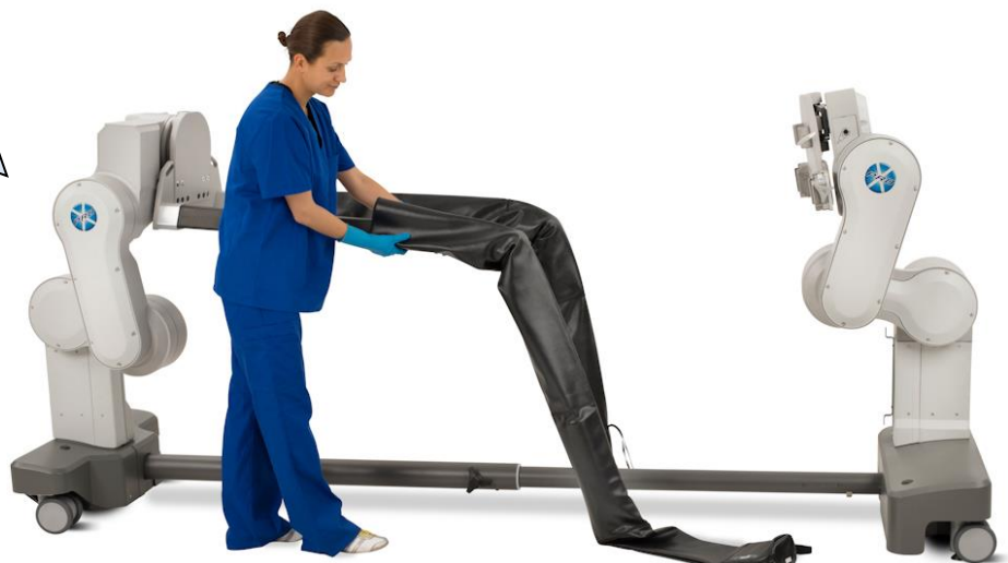
Abbildung 50: Anbringen der Holmabdeckungen
