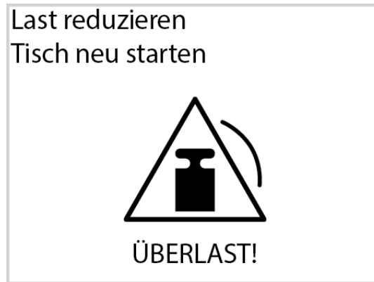
Abbildung 56: IntelliPendant®-Anzeige bei Auslösung der Überlastungsmeldung des IMS
