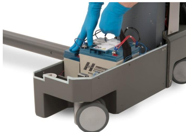
Abbildung 123: Installieren eines neuen Akkupacks
