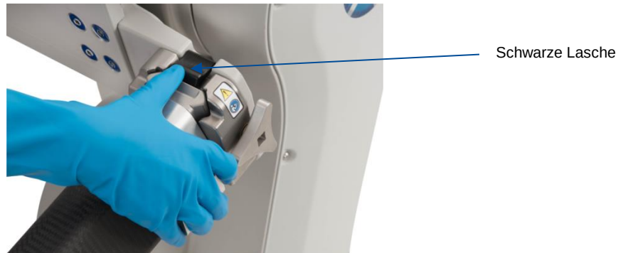
Abbildung 46: Herunterdrücken der schwarzen Lasche zum Abnehmen des Holms
